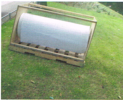
De isolatiedeken wordt op rollen van circa 50 meter aangeleverd met een werkende breedte van 1,45 meter.
